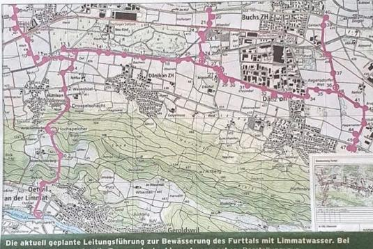
**Die aktuell geplante Leitungsführung zur Bewässerung des Furttals mit Limmatwasser. Bei Oetwil (links unten) ist die Fassung in der Limmat vorgesehen. Darstellung: zvg**
