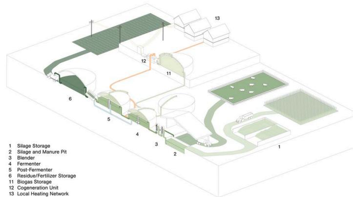
BIOGAS PLANT MODE OF OPERATION
